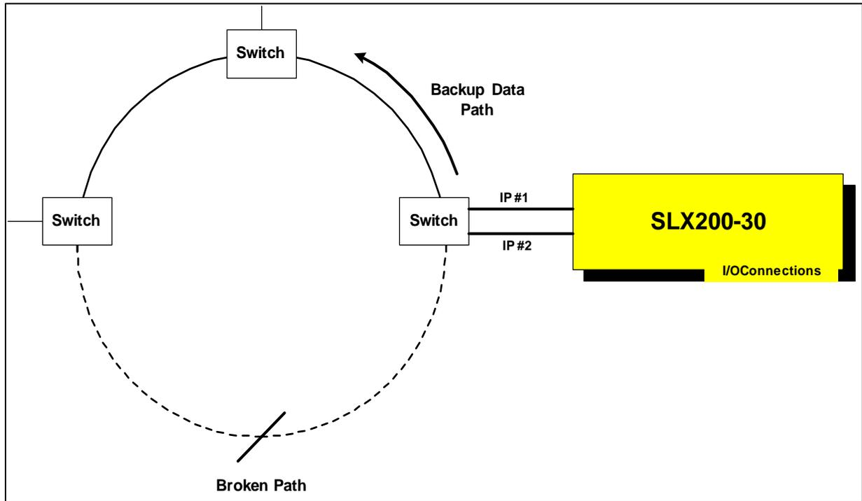
Type 3. Redundant Network Switch(es) or Node(s)
